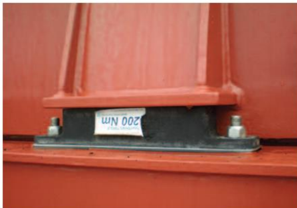
Рис.1. Опорний вкладиш між кришкою та комінгсом трюму
