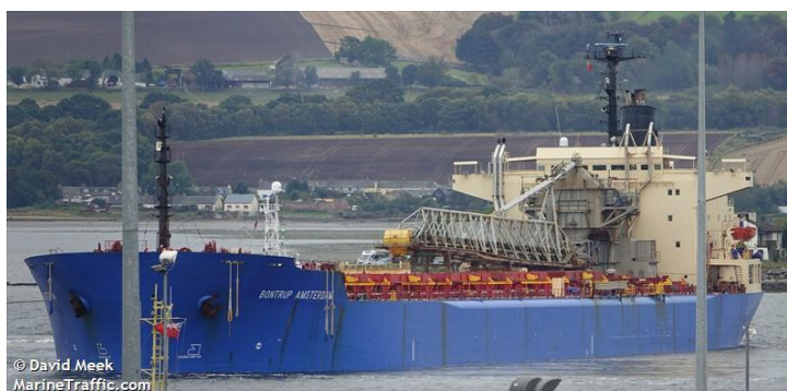
Рис. 2. Самовивантажувальний балкер для перевалки насипних вантажів
