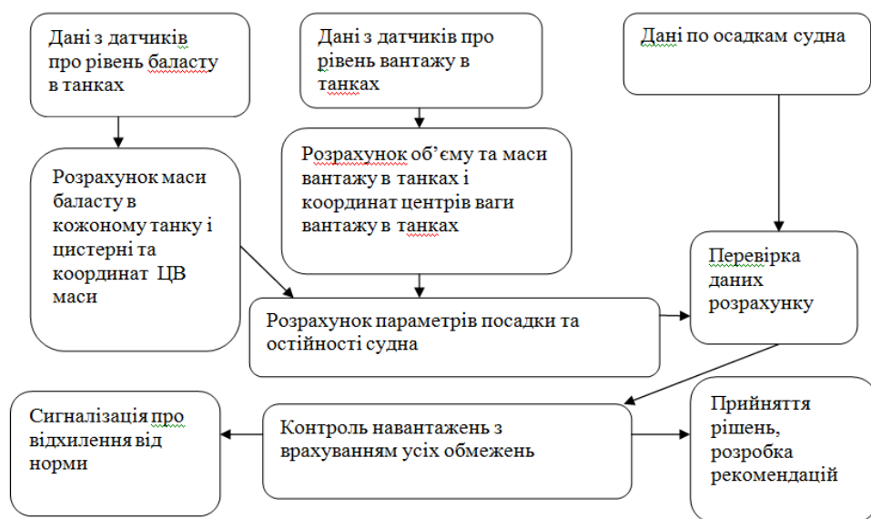
Рис.1. Структурна блок-схема системи автоматичного контролю вантажних операцій танкера
