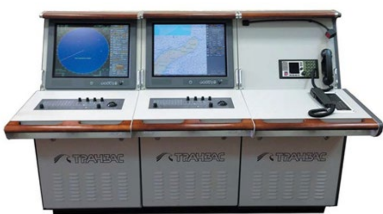
Рис. 4. ЕКНІС яка використовується у комплекті апаратури, призначеному для забезпечення плавання в Арктиці
