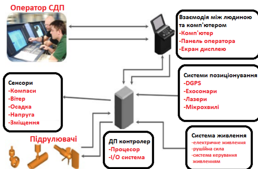
Рис. 1. Загальна схема функціональної системи динамічного позиціонування
