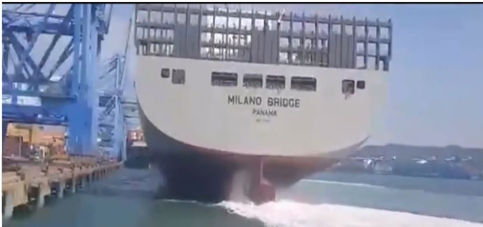
Рис.2- Зануреність гвинта та пера керма
