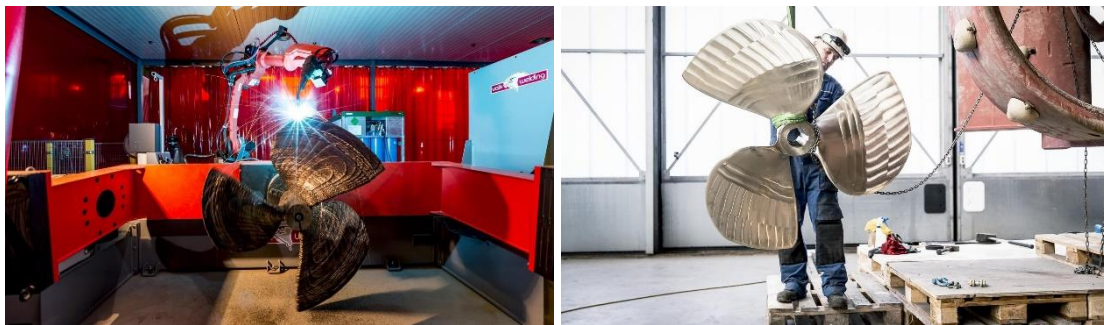
Рисунок 3 та 4. Процес та кінцевий результат виготовлення гвинта компанією RAMLAB.
