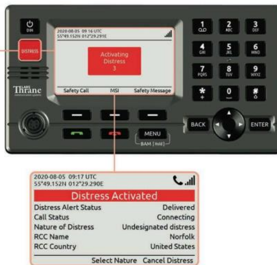
Рисунок 4. Процедура сповіщення про лихо за допомогою Iridium
