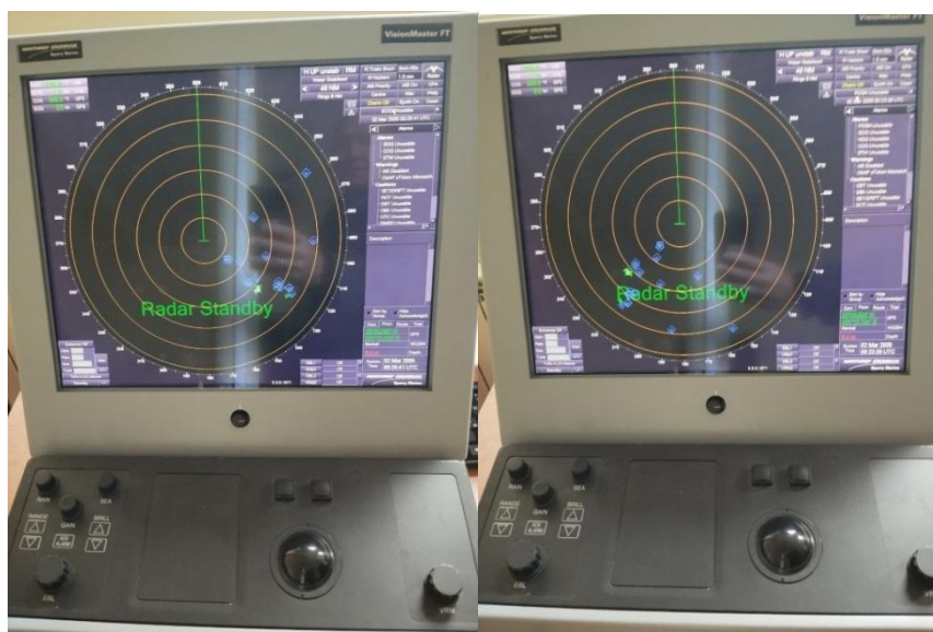
Рисунок 1. Кібервтручання за допомогою «підробки» перешкод на транспондері AIS, інтегрованому з радаром. Розслідується ситуація з дислокацією позначок АІС на екрані радара до кібервтручання (а) і після нього (б). Спостерігаються суттєві відповідні зміни дислокації міток АІС.
