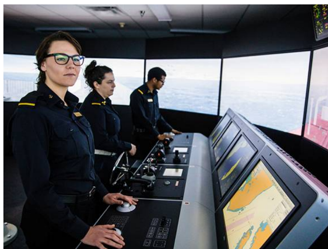
Рисунок 4. Організація робочого простору штурмана з використанням проєкції ЕКНІС на лобове скло містка
