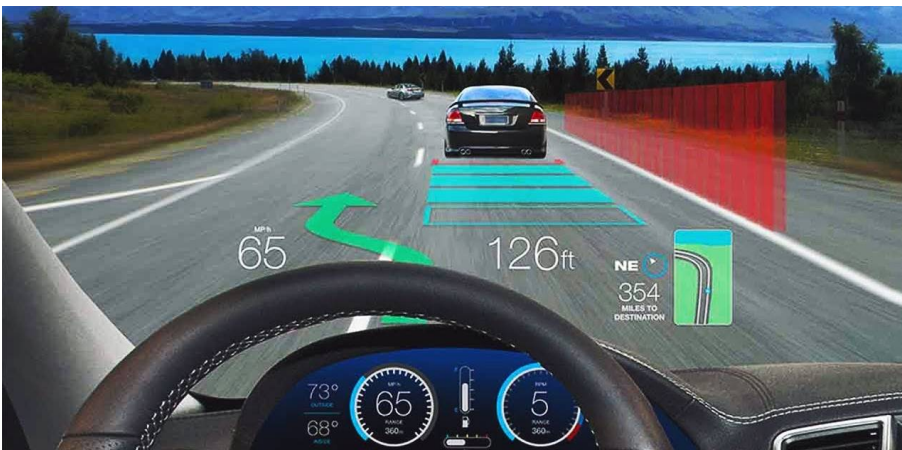
Рисунок 1. Виведення необхідної інформації про рух на лобове скло автомобіля
