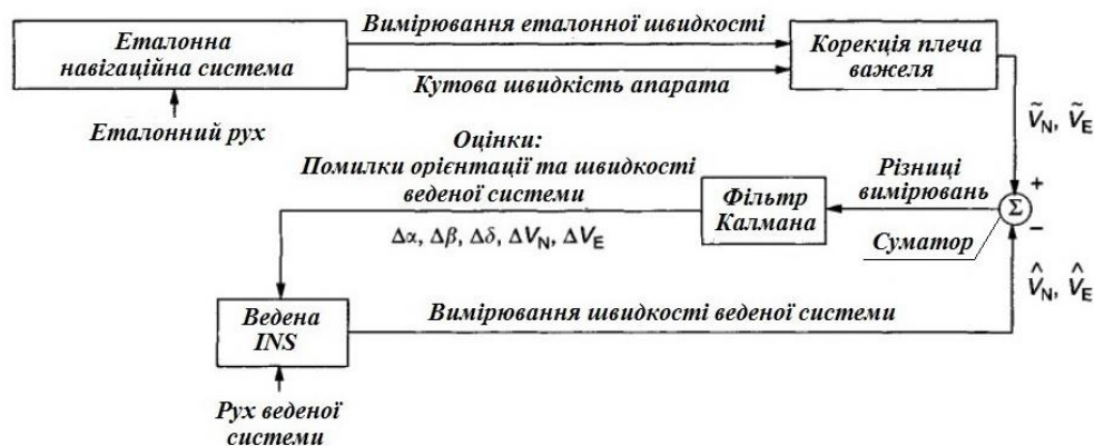
Рисунок 3. Використання фільтрації Калмана у БІНС із застосуванням MEMS
